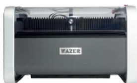
La machine WAZER<sup>®</sup> est équipée d'une pompe haute pression qui atteint une **pression maximale de 317 bars**. La tête de découpe jet d'eau possède un diamètre de jet de 1,2 mm, avec un **débit maximum de 1,9 L/min**. De plus, la machine fonctionne avec de l'abrasif 80 mesh grenat et dispose d'un réservoir d'abrasif d'une capacité de 13,5kg.
