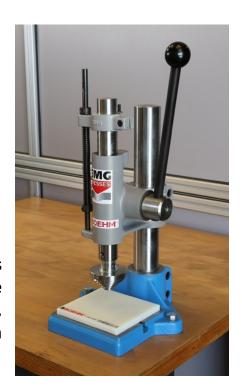
« EMG Presses » propose différents types de presses, dont des presses manuelles parfaitement adaptées pour la découpe circulaire à l'emporte-pièce. BOEHM est le spécialiste de l'emporte-pièce jumelable et interchangeable. Ensemble, ils ont développé un équipement complet, pratique et efficace pour la découpe circulaire de nombreux matériaux. Ils garantissent compétitivité, haute précision, fiabilité et durabilité.
